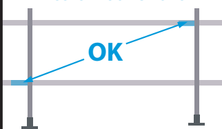
8 Positionnez les brides en respectant un vide de 500 mm maximum.
