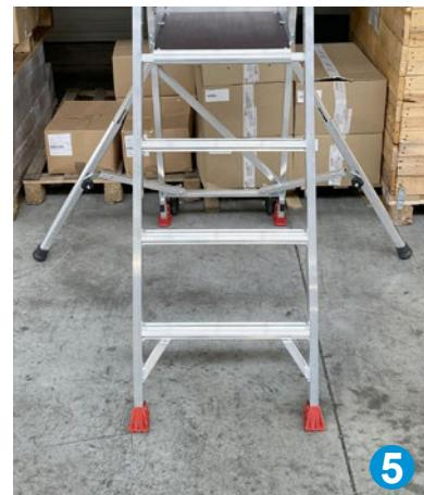
Déployer les stabilisateurs rabattables situés de part et d'autre sur l'arrière de l'escabeau **3** en les déverrouillant à l'aide de la molette **4**. Mettre en place les stabilisateurs **5** et les verrouiller à l'aide de la molette **4**.
