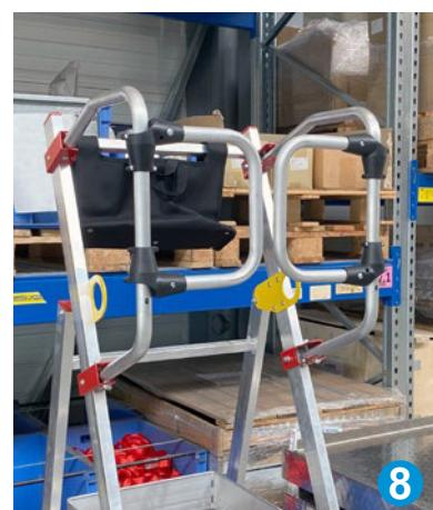
Pour déployer les garde-corps, les pousser vers le haut pour débloquer le verrouillage automatique **6** et tout en gardant la position, les ouvrir jusqu'à la butée d'arrêt **7**. Le verrouillage automatique s'enclenche une fois les garde-corps relâchés **8**. Pour replier les garde-corps, faire la même manipulation **6** et tout en gardant la position, les fermer jusqu'à la butée d'arrêt.
