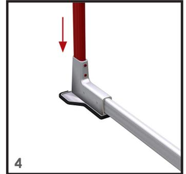
4 Placez le montant et serrez les vis pour le maintenir en position.
