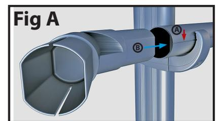
Les lisses doivent être montées à l'horizontal selon le repère (A) pour le montage jonctions (B).
