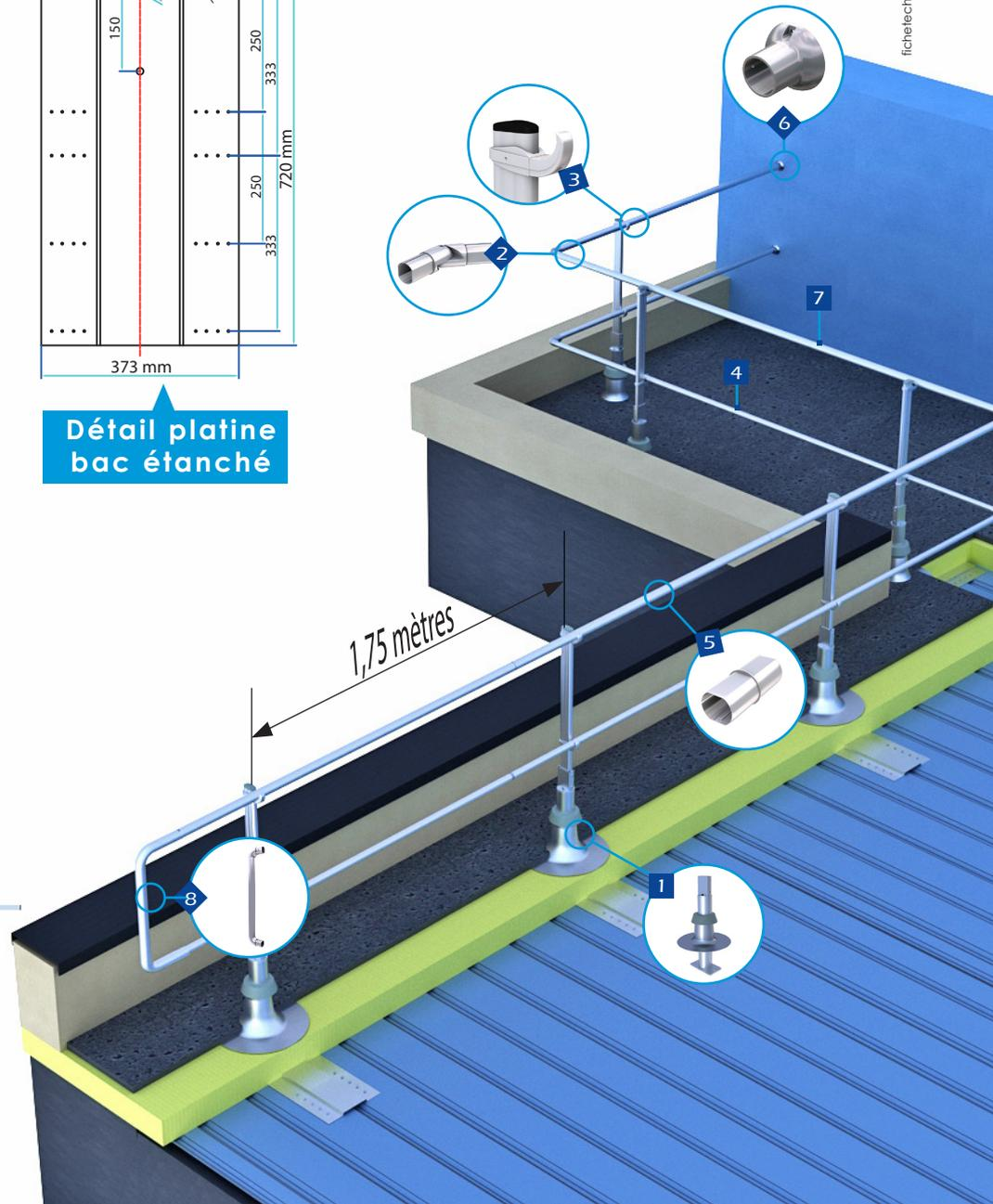
Développé à partir de la gamme standard, l'ensemble des différents modes de fixation sont raccordables entre eux, à l'aide de toutes nos pièces de jonctions de la gamme Oly.
