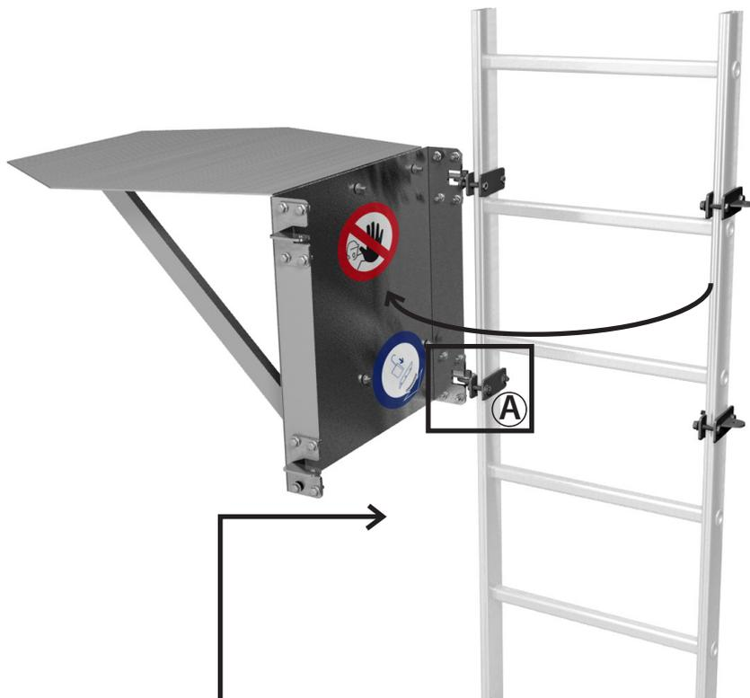
② Ouvrir entièrement de manière à superposer les pattes de verrouillage (figure A) . Refermer à l'aide du cadenas.
