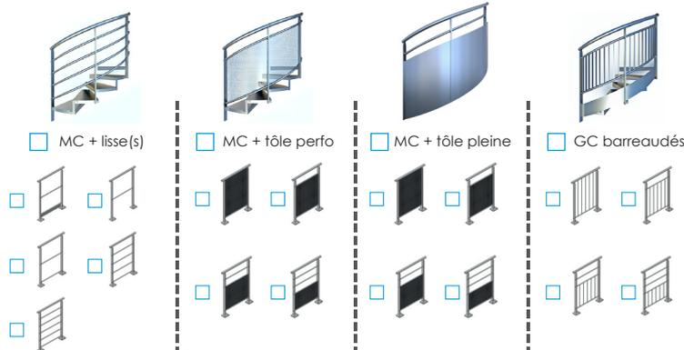
MC + lisse(s)       MC + tôle perfo       MC + tôle pleine       GC barreaudés
