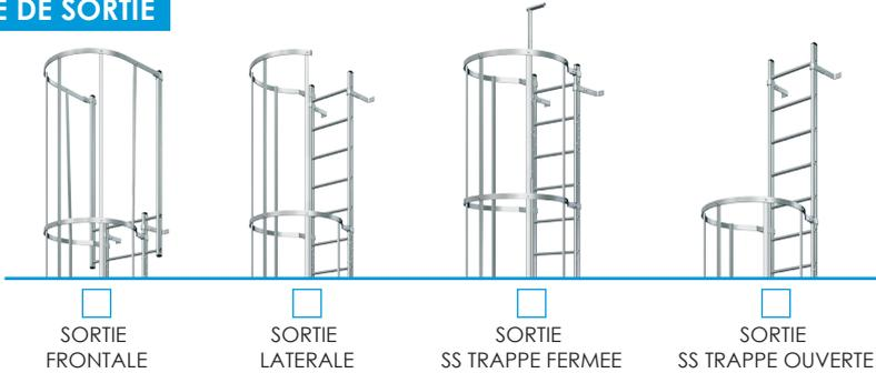
Si l'échelle comprend une ou plusieurs sortie(s) latérale(s) intermédiaire(s), préciser à quel(s) niveau(x) \_\_\_\_\_ mm
