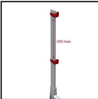
8 Positionnez les brides en respectant un vide de 500 mm maximum.
