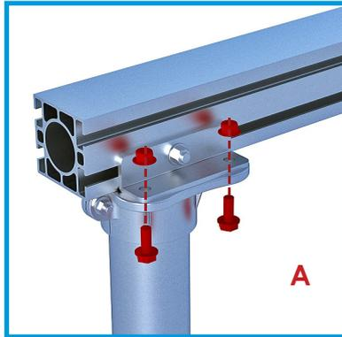
Installation des poutres: Dévissez les boulons de l'équerre et revissez les sur la platine du montant (4 par côté).
