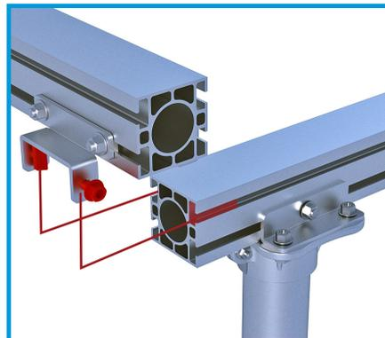
Installation des traverses: Dévissez les vis de la patte de fixation et glissez les dans la gorge haute de la poutre.
