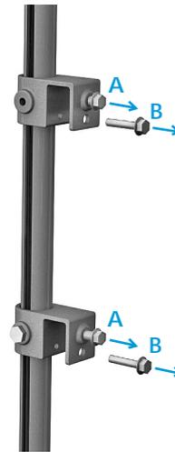
Dessérrez les vis pointeau **A** et enlever les vis de blocage **B**.
