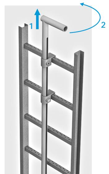
Pour sortir: Levez la crosse jusqu'en butée et tournez la d'1/4 de tour dans le sens inverse inverse des aiguilles d'une montre. Elle est verrouillée.
