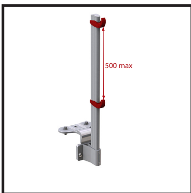
5 Positionnez les brides en respectant l'entraxe maximum.
