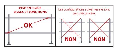
Pour assurer une rigidité optimum, positionner les jonctions à 150 mm maximum des montants.
