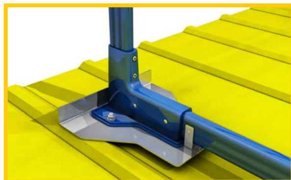
Le garde-corps Olystabac se pose directement sur la toiture. Sa mise en œuvre ne nécessite aucun percement ni reprise d'étanchéité. Sa conception est conforme à la norme Française NF E85 - 015 et à la norme européenne NF EN ISO14122-3.
