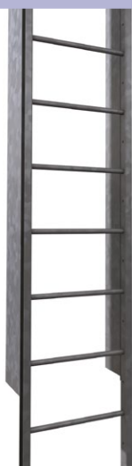
JOUES LATÉRALES interdisant l'accès par l'arrière
