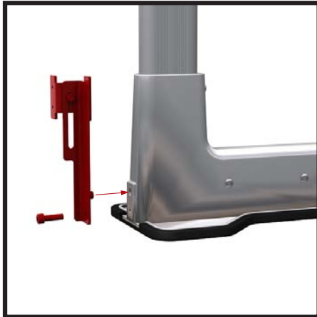
1 Présentez la bride face au talon de l'embase en veillant à placer le téton dans le trou supérieur.
