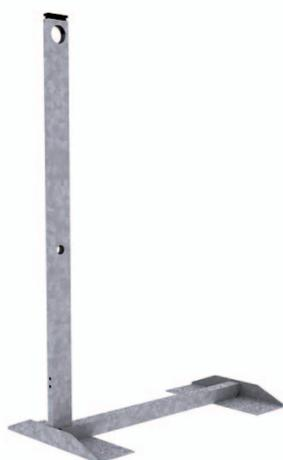
Le garde-corps en acier Gardobac est directement fixé sur le dessus des ondes à l'aide de 8 vis autoforeuses étanches, il assure une étanchéité parfaite grâce à une semelle mastic étanche entre la platine et le bac.
