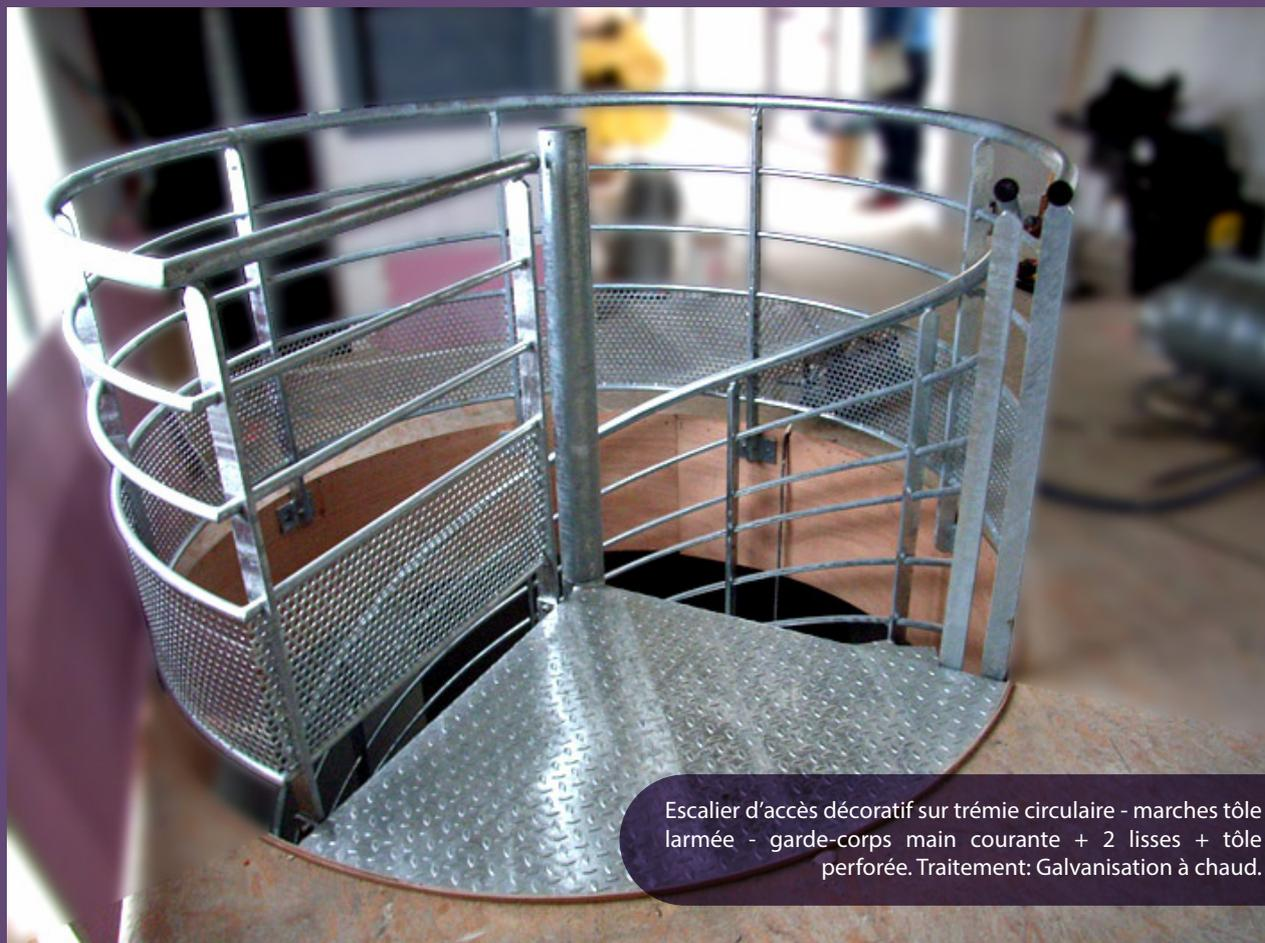
Escalier d'accès décoratif sur trémie circulaire - marches tôle larmée - garde-corps main courante + 2 lisses + tôle perforée. Traitement: Galvanisation à chaud.
